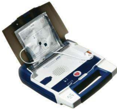
128. kép Újraélesztő készülék
